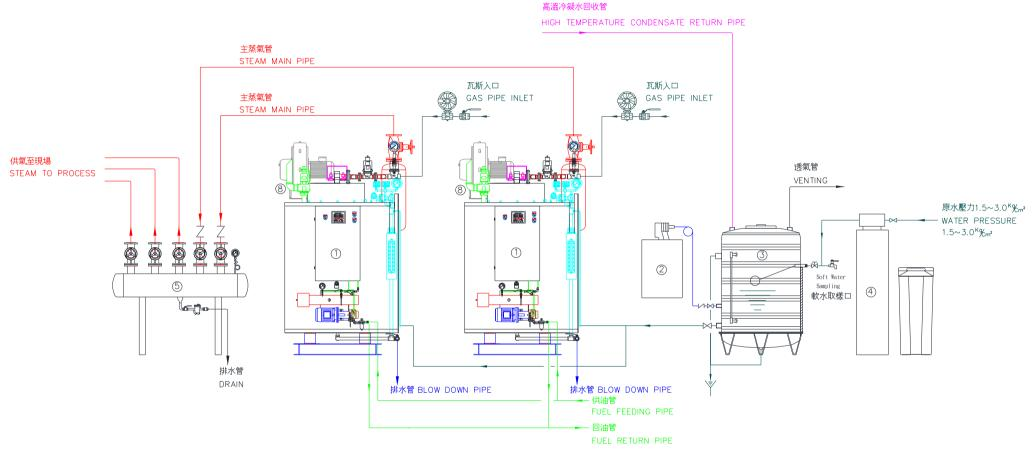
① -全自動貫流式蒸氣鍋爐 AUTOMATIC ONCE THROUGH STEAM BOILER
